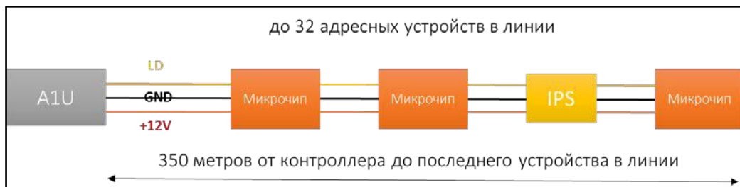
Рисунок 28 – Структурная схема подключения микрочипов к контроллеру
