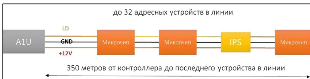
Рисунок 29 – Структурная схема подключения микрочипов к контроллеру
