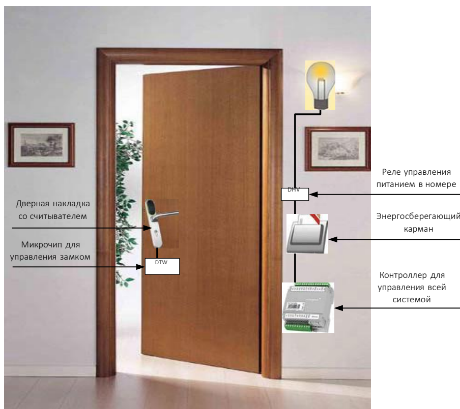
Рисунок 3 – Структурная схема гостиничного номера на базе контроллера А1НТ
