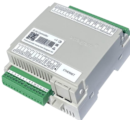
Рисунок 1 – внешний вид контроллера A1TCQ без модуля 4S2R.
