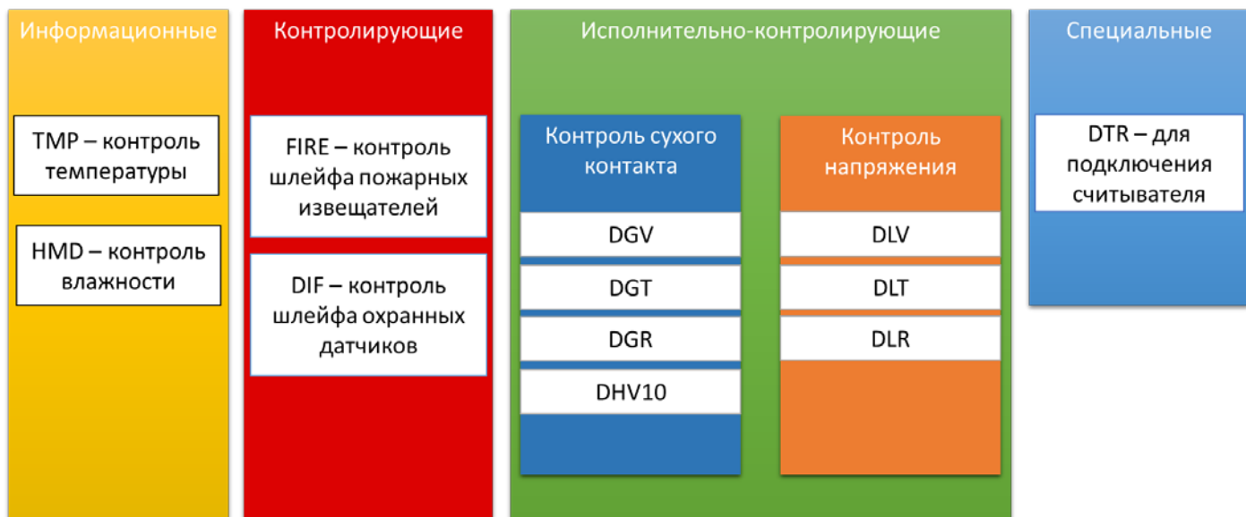
Рисунок 6 – Типы микрочипов, совместимых с контроллером А1U
