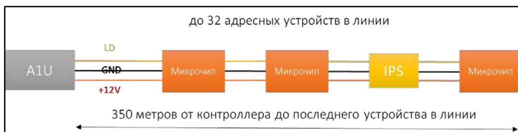
Рисунок 5 – Структурная схема подключения микрочипов к A1U
