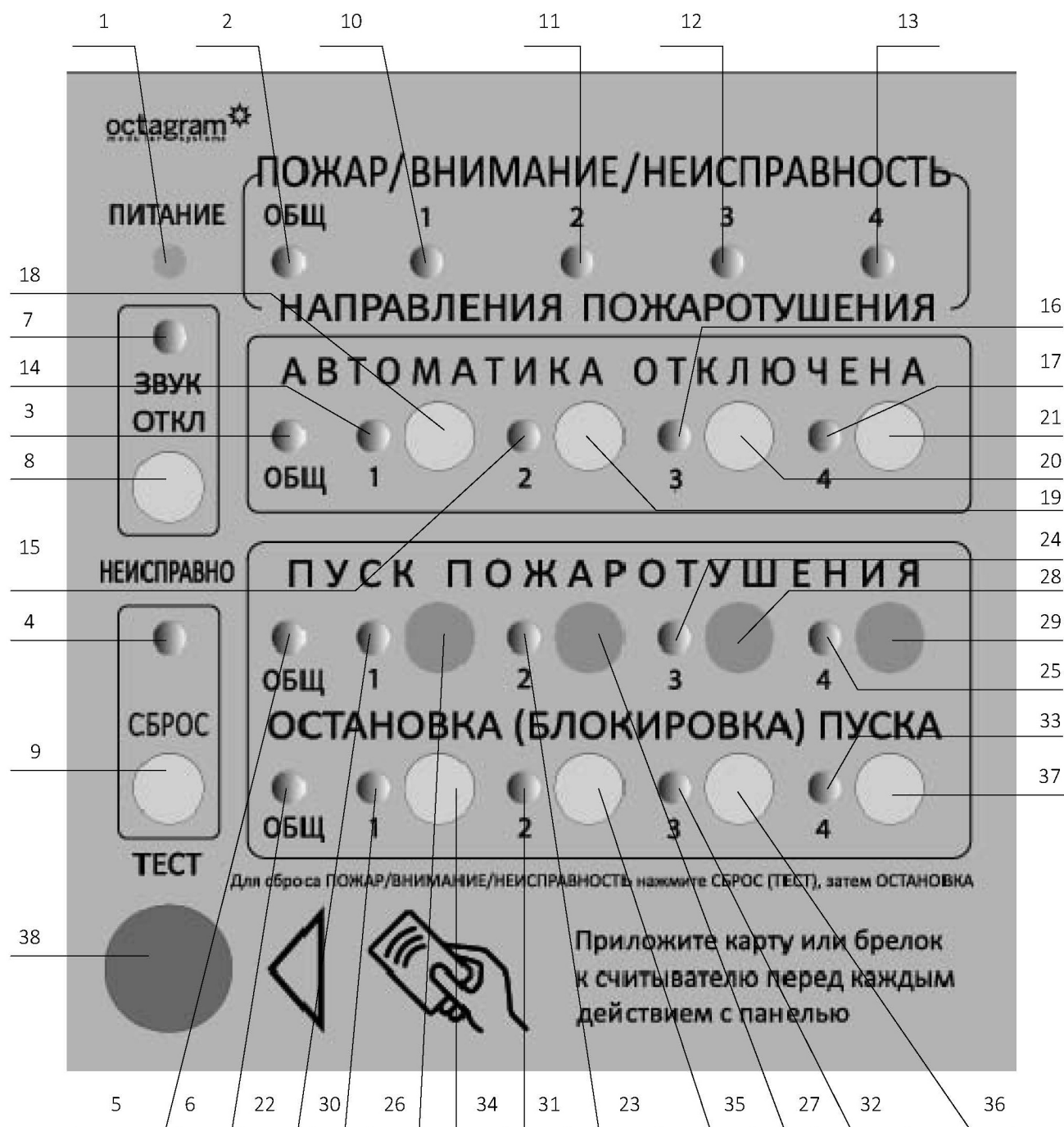
Рисунок 1. Расположение считывателя, световых индикаторов и кнопок прибора FB2 (FB3).
